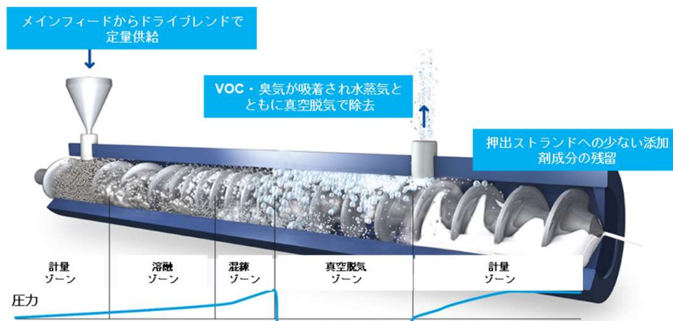
図1：BYK-MAX P 4200 の作用メカニズム
